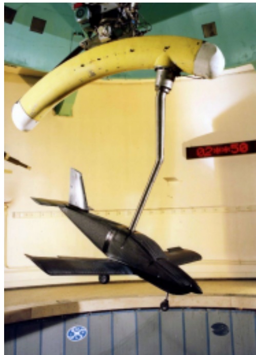
Figure 2 – Maquette d'avion léger monté sur balance rotative dans la soufflerie verticale SV4 du centre ONERA Lille ©Onera
