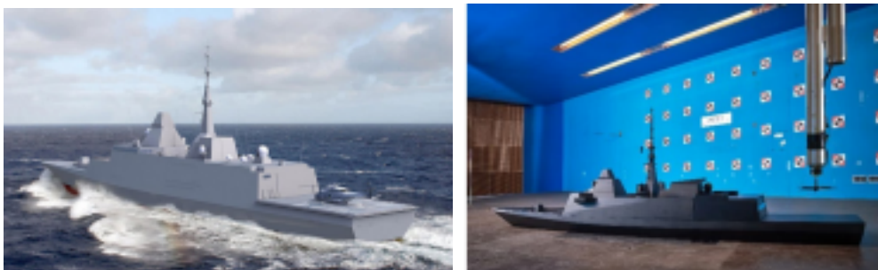
Figure 2 : Photographie de la FREMM(gauche) et de sa maquette en soufflerie (droite)
